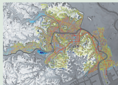
鶴見川低平地における河川と下水道管内水位を統合的に解析する新たな都市浸水モデル A new urban inundation model that comprehensively analyzes water levels in river and drainage systems in the Tsurumi River lowland
