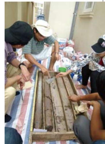
土壌コア、間隙水、地下水の採取と分析
