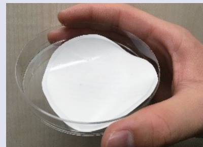
液晶分子が秩序だった構造になる性質を利用した、水を浄化する水処理膜
