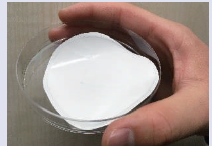
液晶分子が秩序だった構造になる性質を利用した、水を浄化する水処理膜 A water treatment membrane that purifies water by utilizing the property that liquid crystal molecules have an ordered structure
